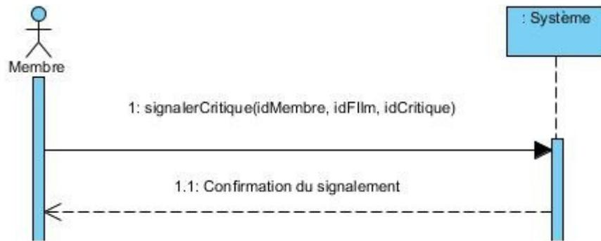
Figure 28: Diagramme de séquences : «Rapporter un abus sur une critique»
